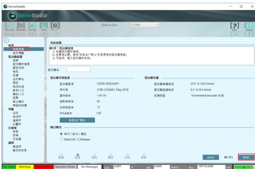
(2) 跳过电机安装过程，点击“写”，确定参数发至驱动器以后，点击 NEXT
