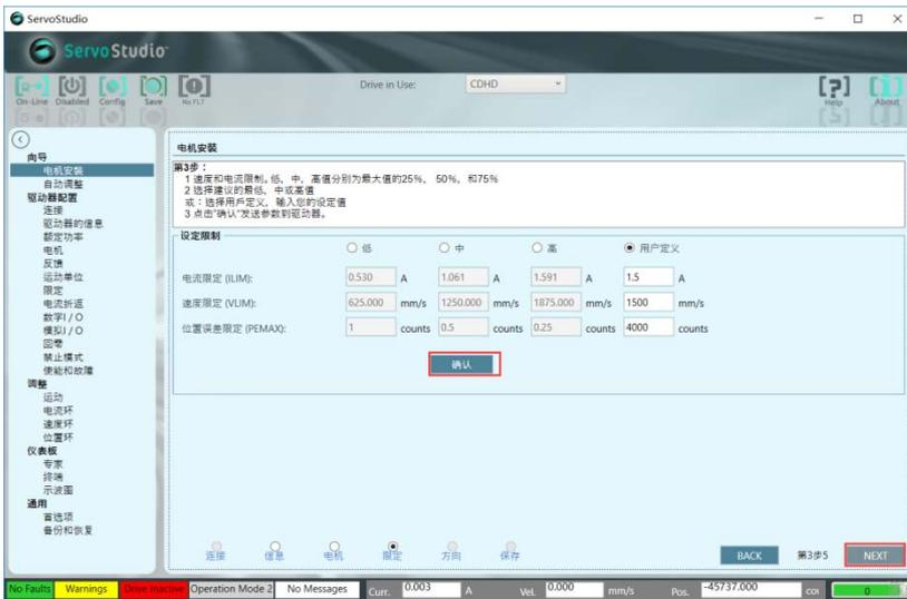
(4) 手动运转，确认电机方向，若电机未运转，可适当增加电机电流，确认方向后点击 NEXT
